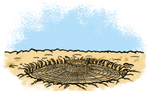
Pose de la cage d'ancrage
